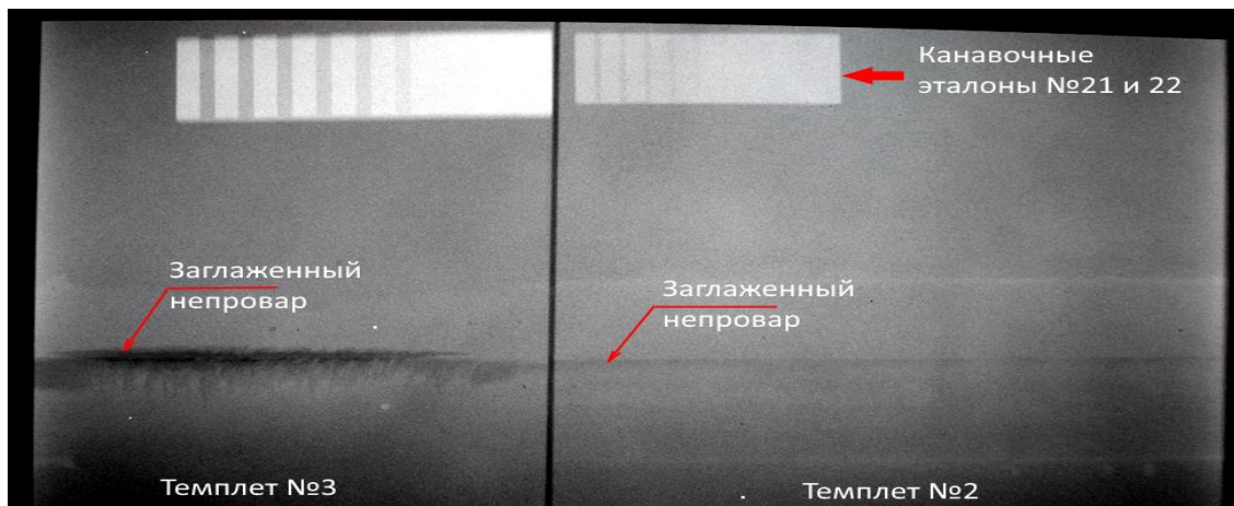
Рис. 3. Радиографический контроль темплета 2 и 3
