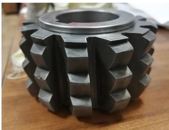
Рис. 4. Изготовленная специальная червячная фреза для обработки винтовых стружечных канавок концевых фрез
