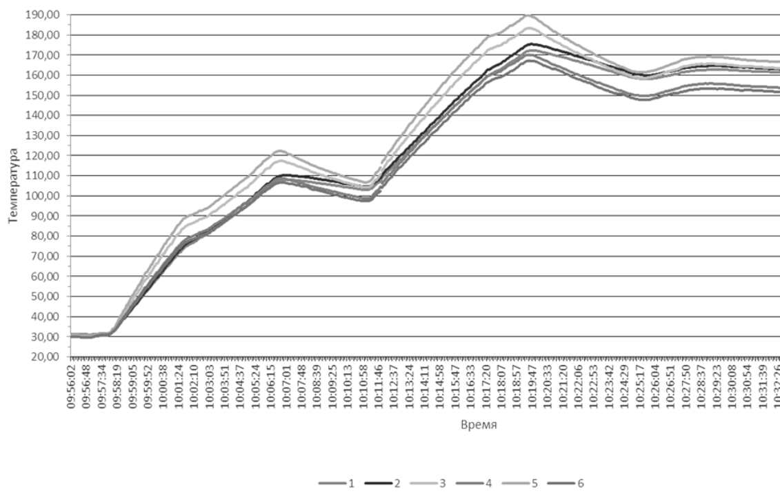
Рис. 5. Экспериментальная зависимость изменения температуры в местах расположения датчиков (см. рис.1) от времени нагрева при выходе на режим нагрева
