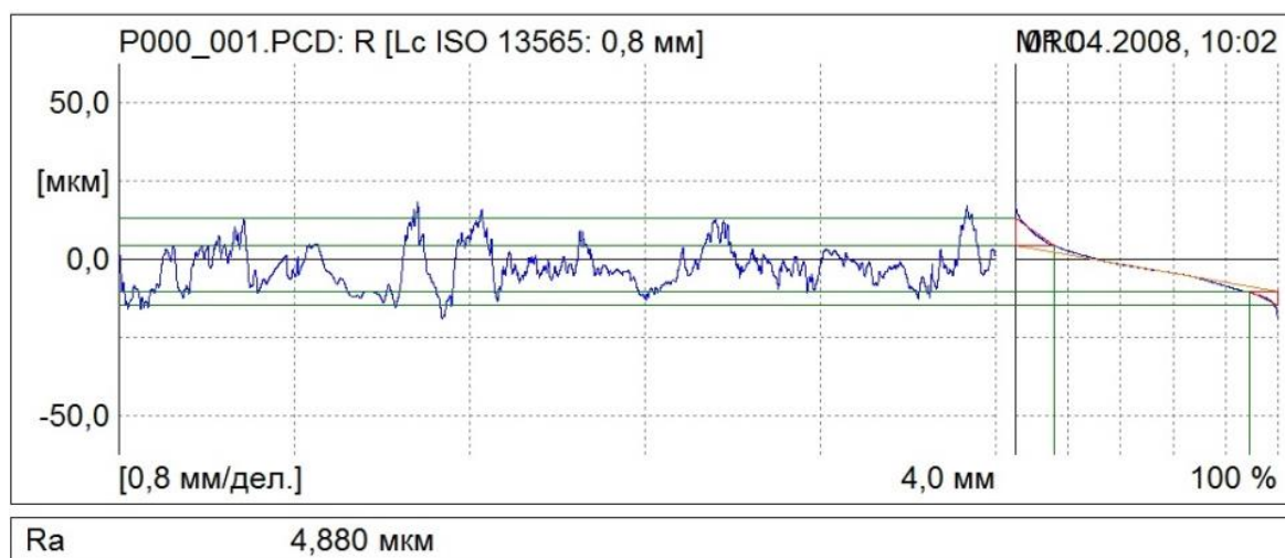
Рис. 4. Профиль поверхности после обработки шлифовальным кругом 63CF54G14 при скорости подачи стола равной 5м/мин
